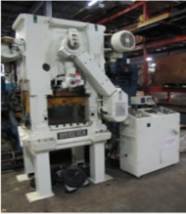
BRUDERER BSTA 30.II 4 POST HIGH SPEED PRESS MFG. 1984
